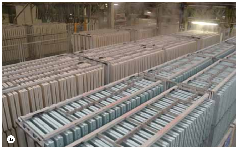
► 01 : Fin de coulée du plâtre dans le moule à carreaux. 02 : Sortie des palettes de carreaux après houssage. 03 : Chariots de carreaux de plâtre en attente de séchage.
