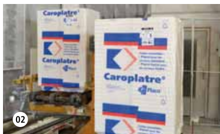
► 01 : Fin de coulée du plâtre dans le moule à carreaux. 02 : Sortie des palettes de carreaux après houssage. 03 : Chariots de carreaux de plâtre en attente de séchage.
