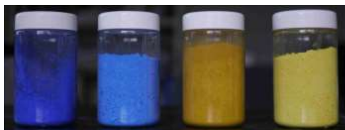
A l'état pur, de gauche à droite : bleu outremer, bleu de cobalt, oxyde jaune, jaune de titane nickel.
