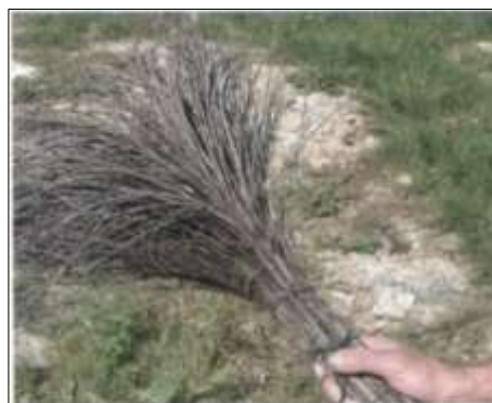
1. Balai de genêts. Même aspect qu'avec l'enduit de chaux.
