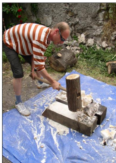
Après cuisson, battage des blocs de gypse. Photo MAP
