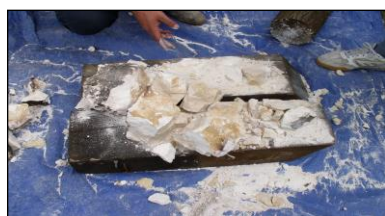
Détail d'un bloc de gypse cuit après un premier coup de masse en bois. L'enveloppe externe du bloc est surcuite, l'intérieur est cuit. Photo MAP.
