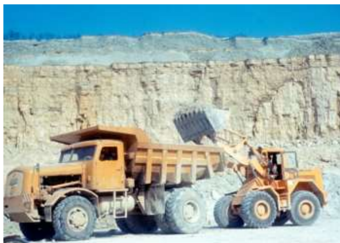
► 24 - Chargeuse sur pneus versant du gypse dans un tombereau de carrière Kaelble, 1973.
