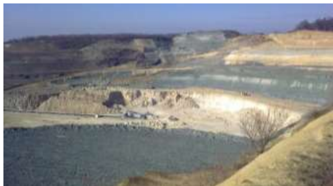
► 4 - Coupe des terrains à la carrière de Cormeilles où l'on observe que l'épaisseur du recouvrement est beaucoup plus importante que celle du gypse, années 1990.
