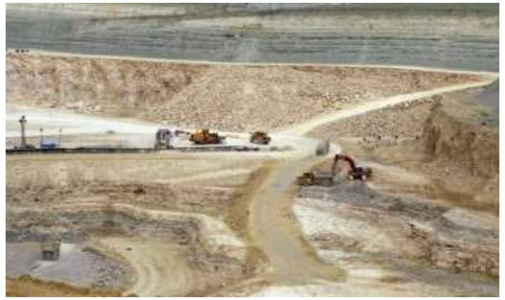
► 26 - Après extraction du gypse, celui-ci est chargé dans un concasseur primaire puis acheminé à la plâtrière par un convoyeur à bande, 1992.
