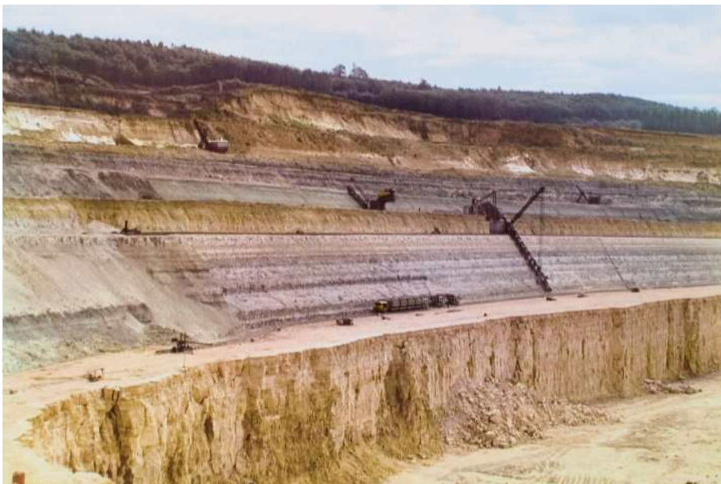
► 15 - Vue de l'ensemble des opérations de découverte (fin des années 1960). Des pelles à câbles travaillent aux niveaux supérieurs. Au niveau central, travaillent les excavateurs à godets. C'est l'une des rares photos où l'on aperçoit, dans le convoi au pied des marnes, un wagonnet jaune équipé d'un compresseur, probablement pour alimenter de l'outillage portatif ou des engins spécifiques.
